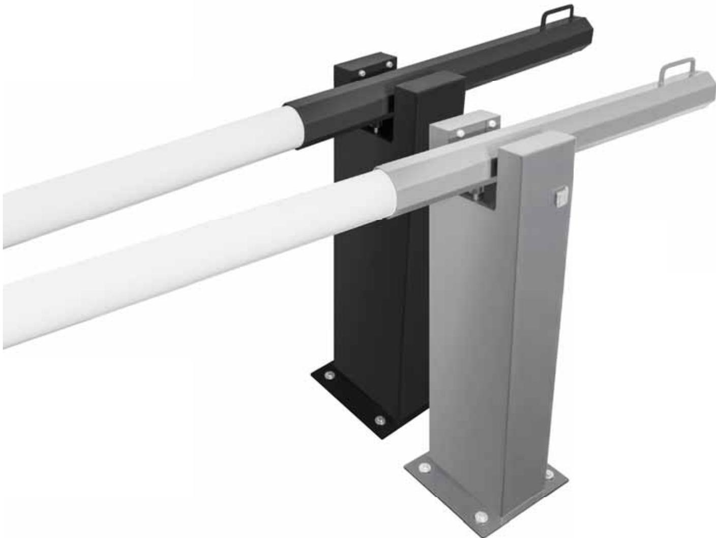
↘ **Barrière manuelle pour passages de 2,5 à 6,5 m, facile et rapide à monter. Possibilité d'utilisation avec lisse ronde disponible dans les tailles Ø 70 et Ø 90 mm ou avec lisse rectangulaire à profils en caoutchouc**
